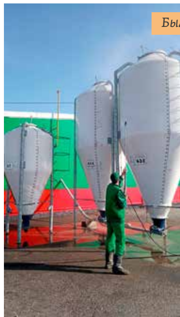
Короткий держатель на оборудовании не позволял провести полную мойку бункера без автовышки.
